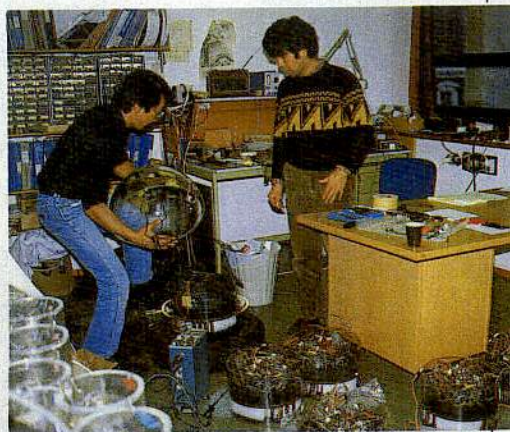
日本から運んできた海底地震計の組み立て作業はベルゲン大学で行われた。深海の水圧に耐えるために、直径43cmの強化ガラスの球に入れられる。
